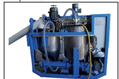
Abb. 7 Momps mit Wiegeeinrichtung und Zementförderschnecke Momps with weighing system and cement screw conveyor
